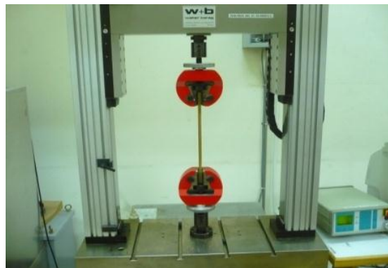
ภาพที่ 17. การทดสอบค่าการรับแรงดึงขนานเส้น
