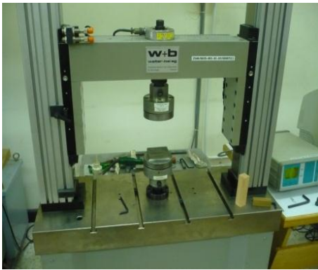
ภาพที่ 13. การทดสอบค่าการรับแรงอัดขนานเส้น
