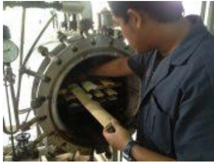
ภาพที่ 8. การนำไม้ไผ่ออกจากตู้ Heat treatment
