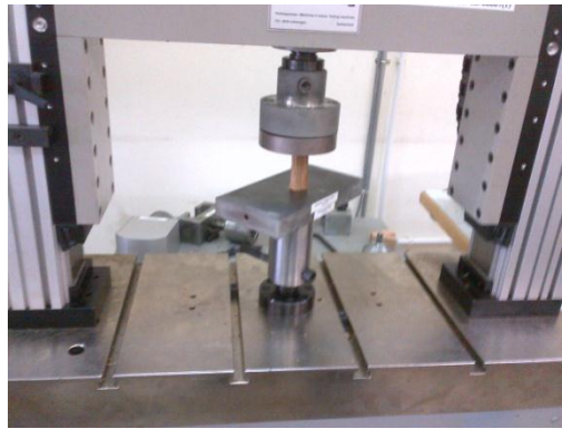
ภาพที่ 13. การทดสอบค่าการรับแรงอัดขนานเส้น
