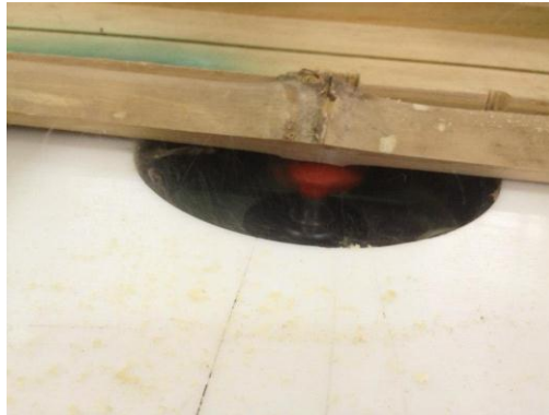
ภาพที่ 3. การกัดข้อไม้ไผ่ด้วยดอกกัดเครื่องเรพท์เตอร์หัวล่าง
