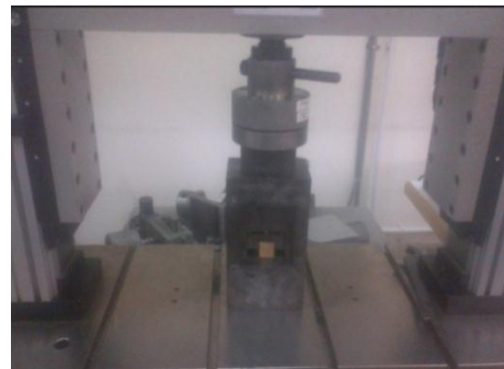
ภาพที่ 16. การทดสอบค่าการรับเฉือนขนานเส้น
