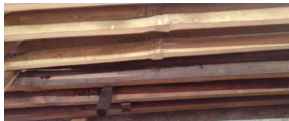
ภาพที่ 9. ไม้ไผ่เมื่อผ่านการ Heat treatment
