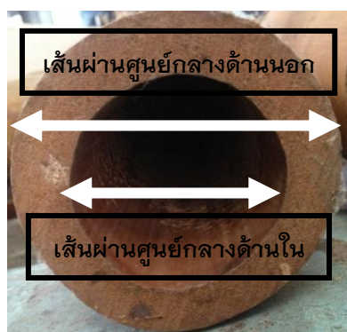
ภาพที่ 5. ตำแหน่งการวัดไม้ไผ่แบบลำก่อนทำการ Heat Treatment
