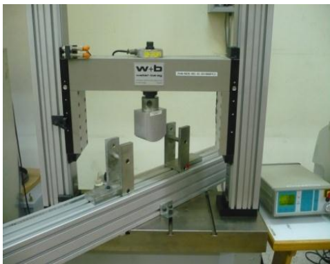
ภาพที่ 11. การทดสอบค่ามอดูลัสแตกร้าวและมอดูลัสยืดหยุ่น
