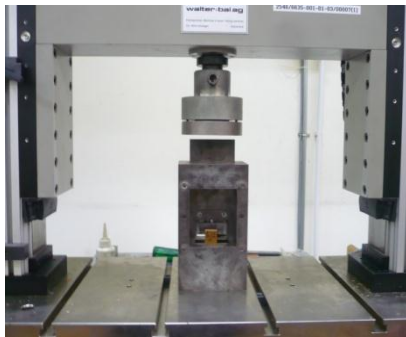
ภาพที่ 16. การทดสอบค่าการรับเฉือนขนานเส้น
